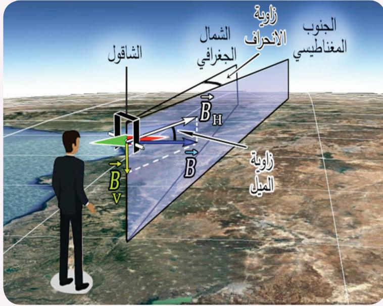
**ملاحظة:** تأخذ الإبرة المغناطيسيّة لبوصلة محور دورانها شاقوليّ منحى المركبة الأفقيّة للحقل المغناطيسيّ الأرضيّ  $\vec{B}_H$  في مُستوي الزوال المغناطيسيّ، في حين تأخذ الإبرة الحرّة الحركة منحى الحقل المغناطيسيّ الكليّ  $\vec{B}$ .
