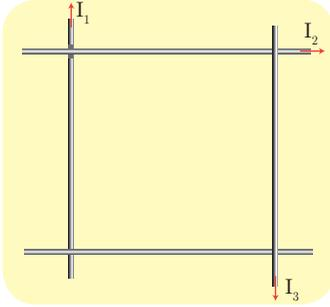
أربع أسلاك ناقلة طويلة تقع في مستو واحد، ومتقاطعة مع بعضها البعض لتشكّل مربعاً طول ضلعه  $40 \text{ cm}$ ، أوجد شدّة، واتجاه التيار الذي يجب أن يمرّ في الناقل الرابع بحيث تكون شدّة الحقل المغناطيسي في مركز المربع معدومة. حيث إن:  $I_1 = 10 \text{ A}$ ,  $I_2 = 5 \text{ A}$ ,  $I_3 = 15 \text{ A}$
