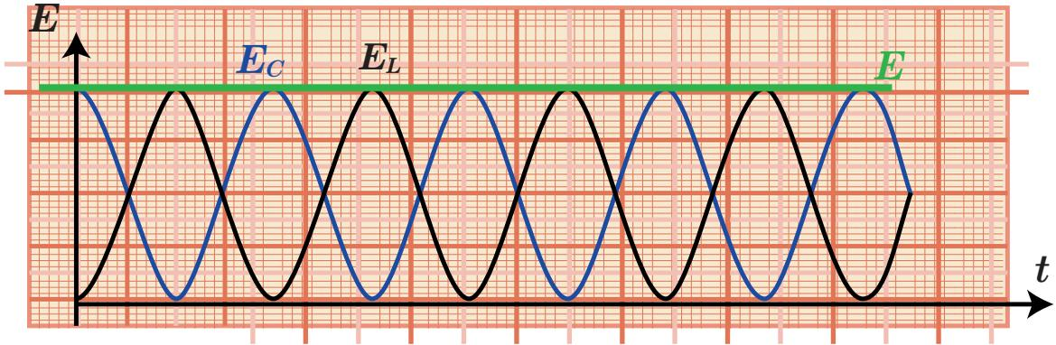
إنّ الطّاقة الكليّة لدارةٍ تحتوي مُكثِّفةً وذاتيّةً صرفةً (ليس لها مُقاومة) ثابتةً وتساوي الطّاقة العظمى للمُكثِّفة المشحونة أو تساوي الطّاقة العظمى للوشيعة؛ أي أنه في دارةٍ مُهتزةٍ في أثناء التّفريغ تتحوّل الطّاقة بشكلٍ دوريٍّ من طاقةٍ كهربائيّةٍ في المُكثِّفة إلى طاقةٍ كهربائيّةٍ في الوشيعة وبالعكس، ولكنّ المجموع يبقى ثابتاً.
