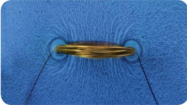
في إحدى التجارب مرر تيار كهربائي متواصل شدته 10 A في ملف دائري نصف قطره 10 cm، وقيست شدة الحقل المغناطيسي بوساطة مقياس تسلا في مركز الملف، وكُرت التجربة السابقة من أجل ملفات متماثلة في نصف قطرها الوسطي ومختلفة في عدد لفاتها، وكانت النتائج وفق الجدول الآتي
