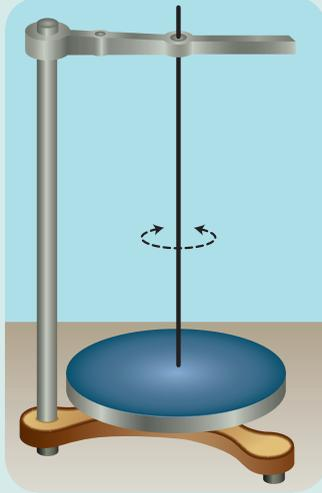
يتألّف نوّاس فتل من قرص متجانس كتلته  $m = 2 \text{ kg}$ ، نصف قطره  $r = 4 \text{ cm}$ ، معلّق من مركزه إلى سلك فتل شاقوليّ ثابت فتله  $k = 16 \times 10^{-3} \text{ m.N.rad}^{-1}$ ، ندير القرص في مستوٍ أفقيّ زاوية  $\theta = +\frac{\pi}{4} \text{ rad}$  عن وضع توازنه، ونتركه دون سرعة ابتدائيّة في اللحظة  $t = 0$ .
