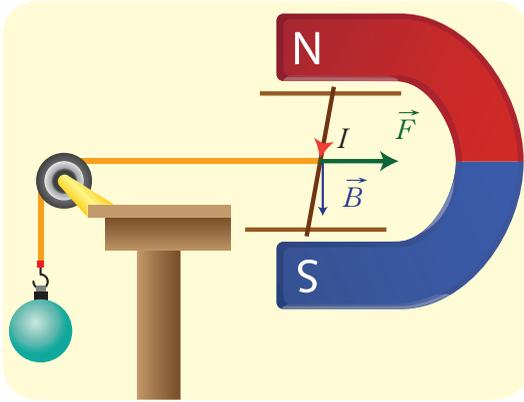
في الشكل المجاور تستند ساق نحاسية طولها  $10 \text{ cm}$ ، وكتلتها  $20 \text{ g}$  على سكتين نحاسيتين أفقيتين، وتخضع بكاملها لحقل مغناطيسي منتظم شاقولي شدته  $B = 8 \times 10^{-2} \text{ T}$  ويمرّ فيها تيار كهربائي متواصل شدته  $25 \text{ A}$  وللحفاظ على توازن هذه الساق نعلق في مركز ثقلها خيطاً لا يمتدّ كتلته مهملة، مربوطاً بكتلة،
