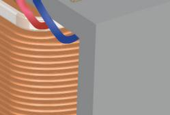
نسمى دائرة الوشيعة التي تتلقى التيار المتساوب بالوشيعة الأولية، ويرمز لعدد لفاتها  $N_p$  ، وللتواتر المنتج المطبق بين طرفيها  $U_{eff_p}$  وللشدة المنتجة المارة فيها  $I_{eff_p}$  .
