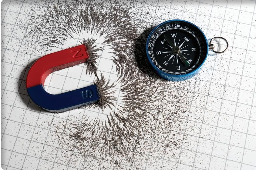
تأخذ الظواهر المغناطيسية أهمية متنامية في حياتنا اليومية فنجد أن سماعة الهاتف تحتوي مغناطيساً كما أن المولدات الكهربائية والمحركات الكهربائية البسيطة وأشرطة التسجيل ومشغلات الأقراص الصلبة داخل أجهزة الحاسوب جميعها تعتمد على الأثر المغناطيسي، ويُستعمل المغناطيس الكهربائي أيضاً لرفع الكتل الحديدية الكبيرة. فما المغناطيس؟ وما المواد المغناطيسية؟ وما المواد غير المغناطيسية؟ وما الحقل المغناطيسي؟ وما علاقته بالتيار الكهربائي؟
