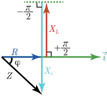
3. عندما تكون رديّة الوشيعة  $X_L$  تساوي اتساعية المكثفة  $X_C$ ، يكون التوتّر متفقاً بالطّور مع الشّدّة، وتسمى هذه الحالة الطّنين الكهربائيّ أو التجاوب الكهربائيّ.
