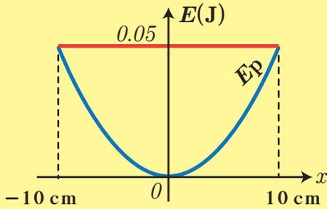
يوضِّح الرسم البياني المجاورُ تغيُّراتِ الطاقةِ الكامنةِ المرّونية بتغيُّرِ الموضعِ لهزّازةٍ توافقيةٍ بسيطةٍ مؤلّفةٍ من نابضٍ مرّينٍ مهمَلِ الكتلةِ حلقاتُهُ متباعدةٌ ثابتُ صلابتهِ  $k$  معلقٌ به جسمٌ كتلتهُ  $0.4 \text{ kg}$ .
