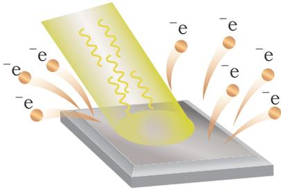
إن عمل هذه الأجهزة يقوم على انتزاع الإلكترونات الحرة من المادة عند تعرّضها لإشعاعات كهرومغناطيسية مناسبة، وهذا ما يسمّى بالفعل الكهروضوئي، وأول من لاحظ هذه الظاهرة عملياً هو العالم هرتز عام 1887.
