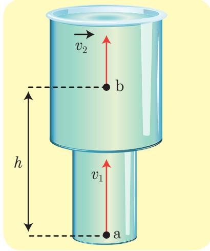
يجري الماء داخل الأنابيب الموضّحة في الشكل من (a) إلى (b) حيث نصف قطر الأنبوب عند (a)  $r_1 = 5 \text{ cm}$  ونصف قطر الأنبوب عند النقطة (b)  $r_2 = 10 \text{ cm}$  والمسافة الشاقوليّة بين (a) و (b)  $h = 50 \text{ cm}$ .
