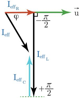
الشدّة المُنتجة تجمع هندسياً:  $\vec{I}_{\text{eff}} = \vec{I}_{\text{effR}} + \vec{I}_{\text{effL}} + \vec{I}_{\text{effC}}$
