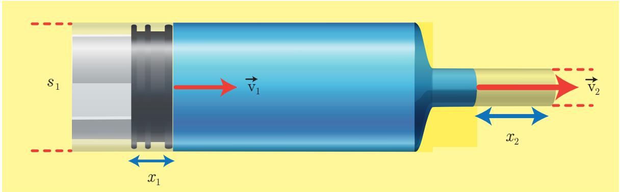
بفرض أنّ سرعة السائل عبر المقطع  $s_1$ ، و  $v_1$  سرعة السائل عبر المقطع  $s_2$ ، فإنّ حجم كمية السائل التي تعبرُ المقطع  $s_1$  لمسافة  $x_1$  في الزمن  $\Delta t$  يكون:
