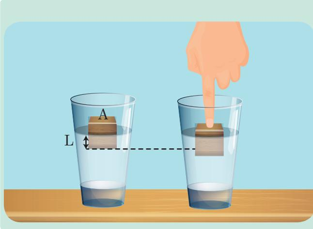
يحتوي كأس ماء كتلته الحجمية  $\rho_{H_2O}$ ، يُوضع فيه مكعب خشبي كتلته  $m_{wood}$  وكتلته الحجمية  $\rho_{wood}$  حيث  $\rho_{wood} < \rho_{H_2O}$  ومساحة سطحه  $A$  فيطفو وهو بحالة توازن وقد برز جزء منه فوق سطح الماء. عند التأثير بقوة شاقولية على المكعب الخشبي ليغمر كلياً بالماء ثم يترك فجأة. ما نوع حركة المكعب الخشبي؟
