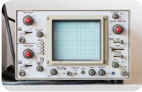
يستخدمُ في دراسة الحركات الدَّورية السَّريعة كالتيارات المُتناوبة والاهتزازات الصَّوتية، حيثُ يُظهرُ تحوُّلات التَّوتُّر بتابعيّة الزَّمن على شكل مُنحن بيانيّ له تواتر الحركة المدروسة نفسه، ويُمكنُ للجهازِ قياسَ فرق الكُمون المُستمرّ أو المُتناوبِ بوساطة الشاشة المُقسَّمة إلى تدرجات مُناسبة، ويُمكنُ التَّحكُّم بقيمة كلِّ تدرجة بوساطة مفتاح خاصّ.
