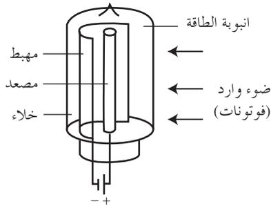
تتألف الخلية الكهرضوئية من حِبابَة زجاجية من الكوارتز مُخلّاة من الهواء، تحتوي مسرى معدنيًا يُغطّي سطحه طبقة رقيقة من معدنٍ قلويّ تتلقّى الضوء، يُسمّى المهبط C، كما تحتوي على مسرىٍ آخر يُسمّى المصعد A.
