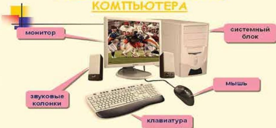
Компьютер принимает, обрабатывает, хранит и выдаёт информацию. Внутренние устройства компьютера служат для хранения и обработки информации. Они находятся в системном блоке.
